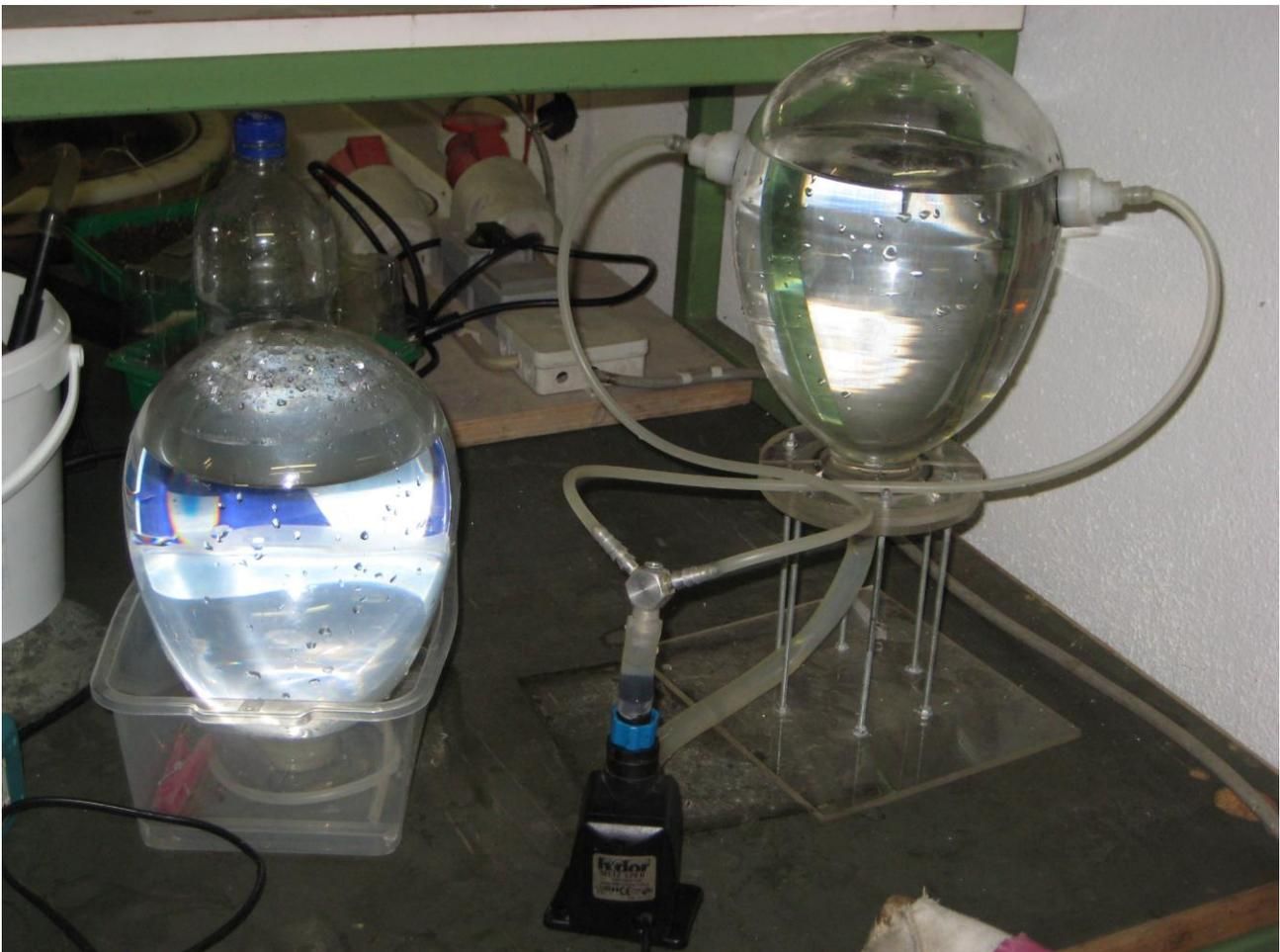
Rechts Herstellung von Wirbelwasser im Glasei, links das unbewegte Wasser für die Kontrollgruppe.
