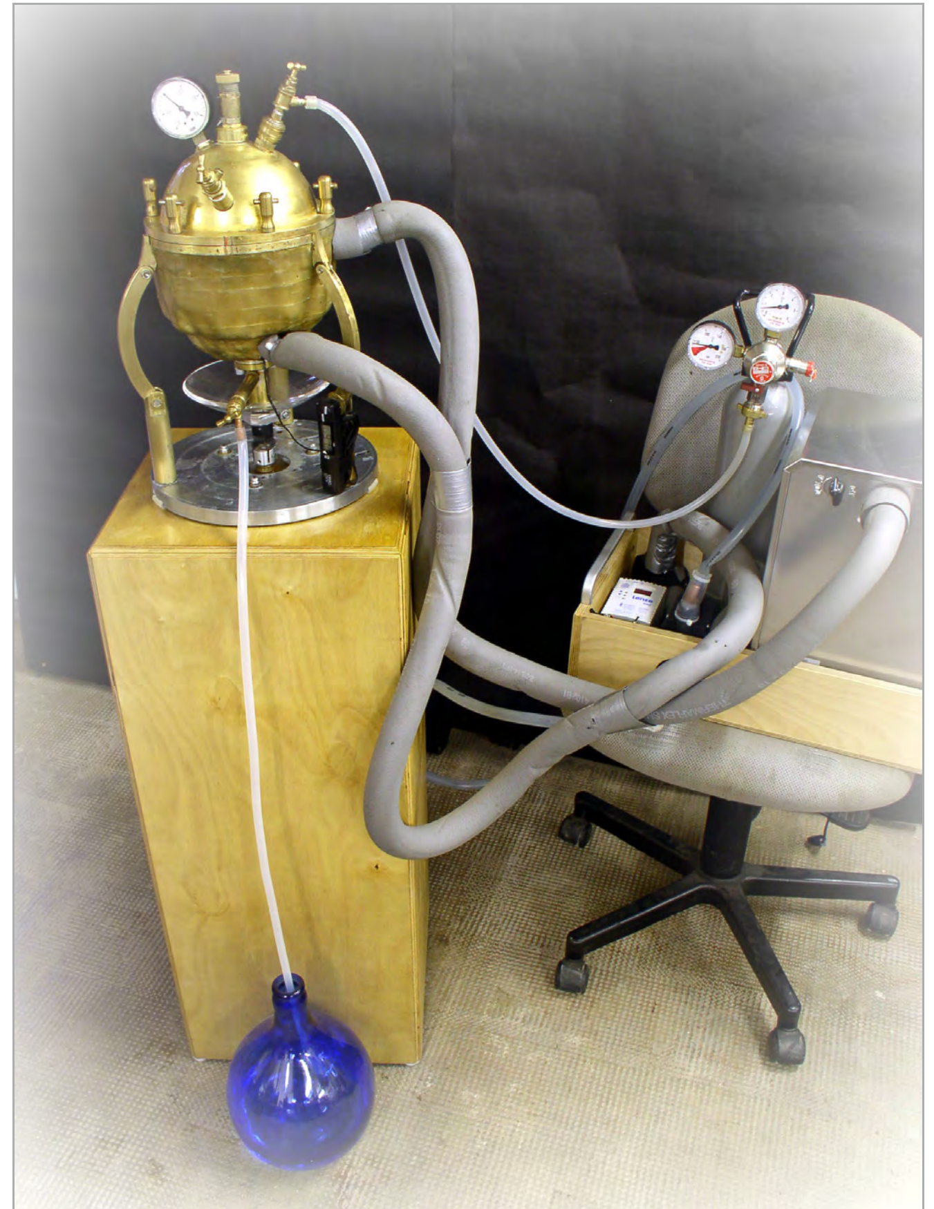
Neustes Edelwassergerät mit Kühlung, CO2 Anschluss und Turbinenantrieb:
